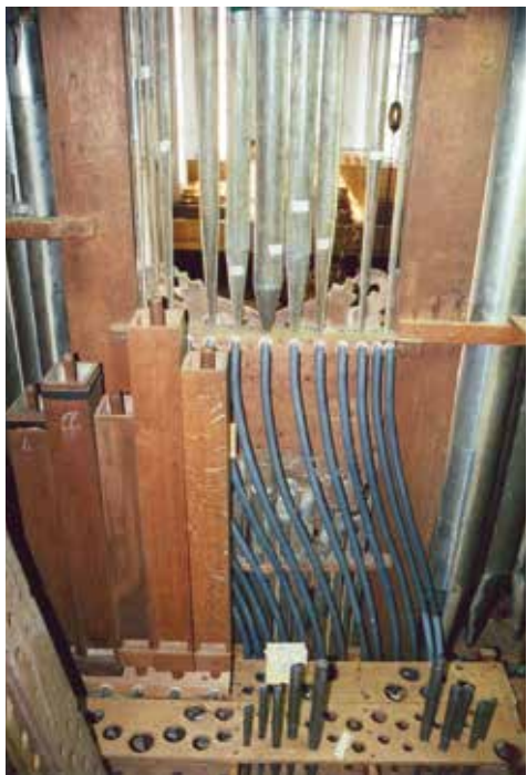
De oude frontpijpen van Schnitger zijn door nieuwe loden conducten weer aangesloten.
