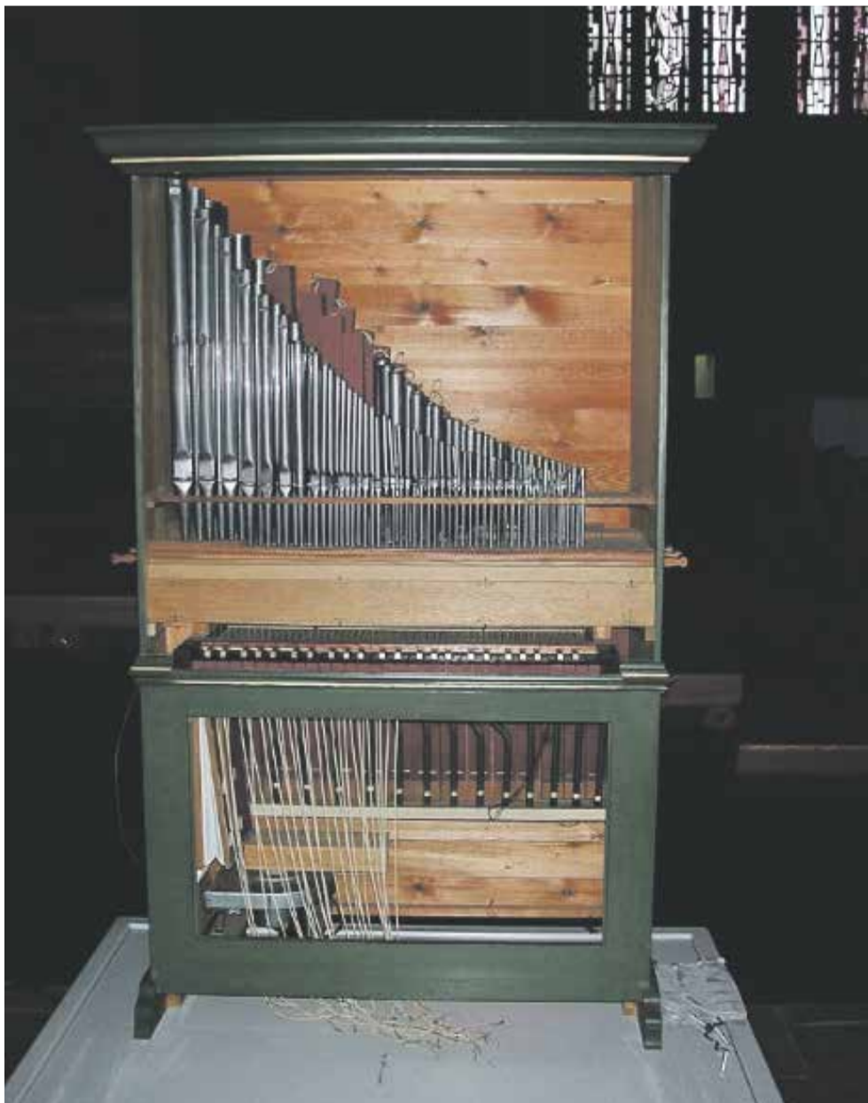
Het Flentrop-positief (II) in 2011. Bovenin zijn de pijpen van de Praestant 2' goed zichtbaar. Het touwmechaniek voor de pedaal koppeling is in 2012/2013 geheel vernieuwd.
